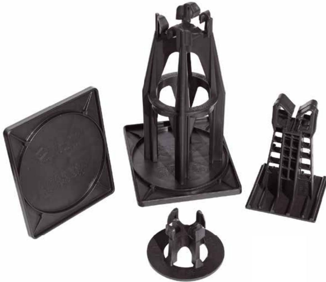
단열재용 제품은 철근받침대를 단열재 위에 시공 때에는 슬라브 두께를 유지하기 위해 반드시 사용해야 하는 제품입니다. 상근용과 하근용 철근받침대의 하부에 단열재용 판이 결합된 제품으로, 철근받침대가 철근의 무게로 인해 단열재를 뚫고 들어가는 것을 방지 합니다. 기존 철근받침대를 사용해야 할 경우 단열재용 사각판을 함께 사용할 수 있습니다.
