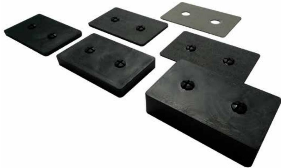
플라스틱 조립 플레이트는 PC패널을 시공할 때 패널의 높이 조절용으로 사용됩니다. 제품 상부에 돌기가 있어 여러 개의 제품이 겹쳐졌을 때 미끄러지지 않도록 제작하였고, 시공 후에는 PC패널의 무게에 의해 미끄럼 방지용 돌기가 제품내부로 들어가게 되어 있습니다. 1mm제품은 다른 두께의 제품과 다른 색상으로 제작하여 현장에서 쉽게 구별 할 수 있도록 제작하였습니다.
