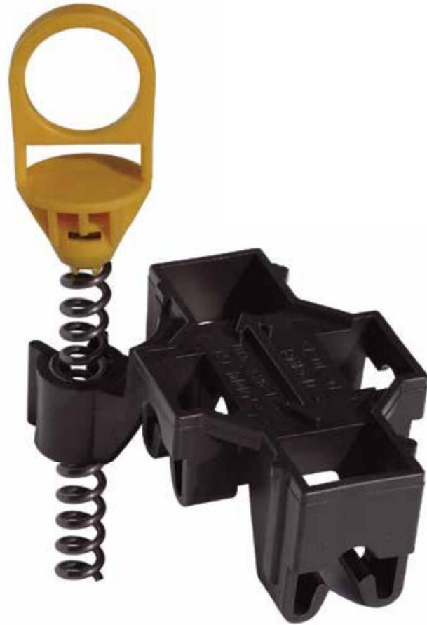
데크 겸용 레벨러는 주근의 굵기가 10mm인 경우와 13mm인 경우에 하나의 제품으로 시공이 가능합니다. 데크 겸용 레벨러는 제품 상부에 표시된 화살표를 주근방향과 일치하게 놓고 눌러서 간편하게 시공이 가능하며, 주근과 배력근을 잡아주는 네개의 클립이 제품을 확실하게 고정하게 됩니다. 데크 겸용 레벨러는 철근 굵기와 피복두께에 맞게 각 현장의 맞춤으로 제작되고 있습니다. 장착된 스프링은 반발력이 매우 우수해서 콘크리트 타설시 넘어지지 않고, 노란색 손잡이가 타설 후 눈에 선명하게 확인되어 제거하기 쉽습니다. 작은 부피로 슬라브에 영향을 최소화 할 수 있도록 디자인 하였으며, 매우 간단하게 설치할 수 있어 작업시간을 단축할 수 있도록 하였습니다.
