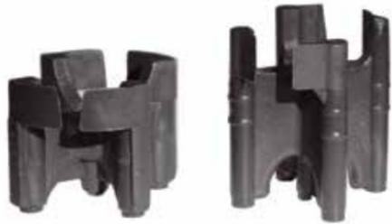
SS는 철근 무게를 버티는 힘이 탁월하며 피복두께를 일정하게 유지하는데 매우 적합합니다. 상부의 클립형 구조로 인해 콘크리트 타설시 철근이 이탈이 되지 않고 깨지거나 넘어지지 않습니다. 거푸집 해체 후 견출이 필요 없으며 매우 경제적인 제품입니다.
